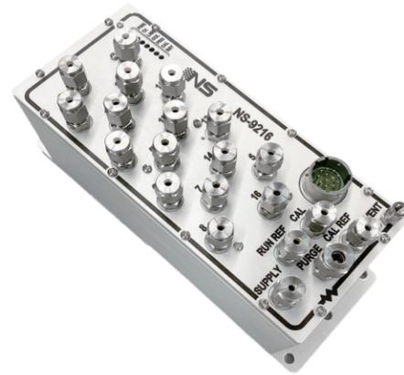
NS-9216电子压力扫描阀是一种高性能一体式气体压力测量装置，用于多通道干燥无腐蚀性气体的压力测量，其内部集成了压力传感器和气路校准阀。NS-9216具有16个测量通道，每个通道使用单独的气体压力传感器，每个传感器内部都具有记忆全部校准数据的嵌入式记忆电路芯片，精度高达±0.05%，通过内部调零校准、量程校准或多点校准功能来维持高精度。
